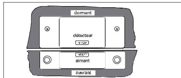
La fixation des deux boîtiers sur le support s'effectue à l'aide de vis de diamètre 4mm maximum.
