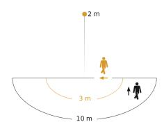
Hauteur d'instal lation: 1,80 m - 3,00 m Orange: sens de passage radial Noir: sens de passage tangentiel
