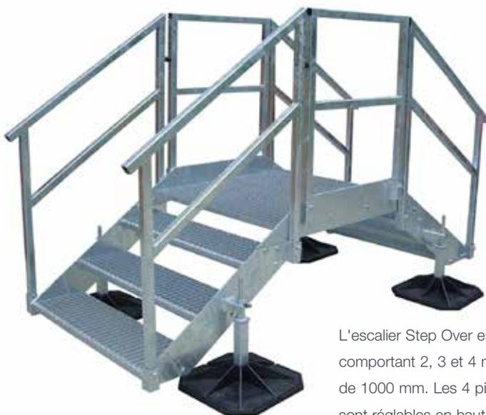
L'escalier Step Over est disponible en 3 modèles comportant 2, 3 et 4 marches ainsi qu'une plateforme de 1000 mm. Les 4 pieds de chaque escalier Step Over sont réglables en hauteur pour le dénivelé du toit et fixés sur des pieds de 305 mm (avec patins anti-vibratiles) pour en assurer la stabilité.
