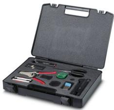
Kit de confection de câbles HCS pour connecteur SC-RJ à montage rapide comprenant un couteau et une pince à dénuder, des ciseaux pour fil aramide, une pince à fibre, un microscope, un outil à entailler les fibres HCS standard et les fibres HCS-GI, deux connecteurs mâles SC-RJ pour fibres HCS standard ainsi que la documentation
