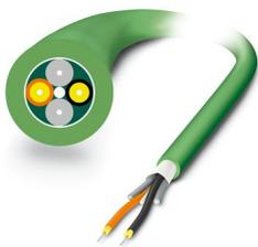
Câble en fibre optique PROFINET-PCF, duplex 200  $\mu\text{m}$ /230  $\mu\text{m}$  pour le câblage dans des installations et machines fixes, type B, gaine extérieure PVC, vendu au mètre sans connecteur
