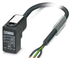
Câble pour capteurs/actionneurs, 3-pôles exempt d'halogène, extrémité libre, sur Connecteur de vanne CI (9,4 mm), avec 1 LED, câblé avec Varistance, longueur de câble: 3 m
