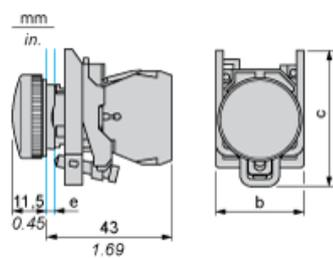
e : épaisseur du dispositif de serrage : 1 à 6 mm / 0,04 à 0,24 pouce
