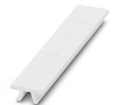
Ruban de repérage ZB, Rubans, blanc, vierge, repérable avec : PLOTMARK, CMS-P1-PLOTTER, type de montage: encliquetage, pour bloc de jonction au pas de : 12,2 mm, surface utile: 12 x 10,5 mm, Nombre d'étiquettes: 5
