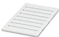
Repères pour blocs de jonction, Planche, blanc, vierge, repérable avec : BLUEMARK ID COLOR, BLUEMARK ID, BLUEMARK CLED, PLOTMARK, CMS-P1-PLOTTER, type de montage: encliquetage, pour bloc de jonction au pas de : 12 mm, surface utile: 11,45 x 10,5 mm, Nombre d'étiquettes: 40
