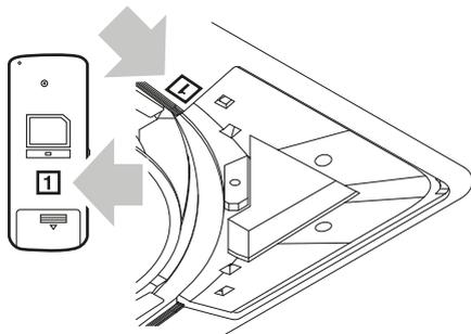
**REMARQUE** Régler le numéro d'unité du récepteur et le dispositif de régulation à distance sans fil pour qu'ils soient les mêmes. Si les réglages diffèrent, le signal du dispositif de régulation à distance sans fil ne peut pas être transmis.
