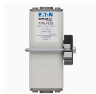
**Cartouche fusible, grande vitesse, 20 A, AC 1600 V, compact size 1, 45 x 45 x 140 mm, aR, IEC, indicateur de fusion simple**
