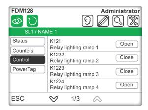
**NOTE**: Lors de l'exploration initiale de la vue d'appareil d'un Acti9 Smartlink ou après la mise à jour de la configuration, l'actualisation des données affichées peut prendre jusqu'à 20 secondes.
