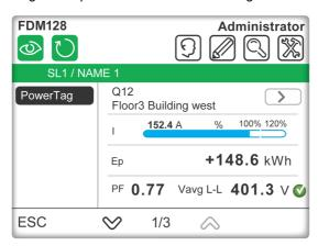
Les informations suivantes sont affichées dans le sous-menu des capteurs d'énergie NSX PowerTag :
