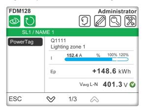
Les informations du sous-menu varient selon le type de capteur d'énergie PowerTag (monophasé ou triphasé).
