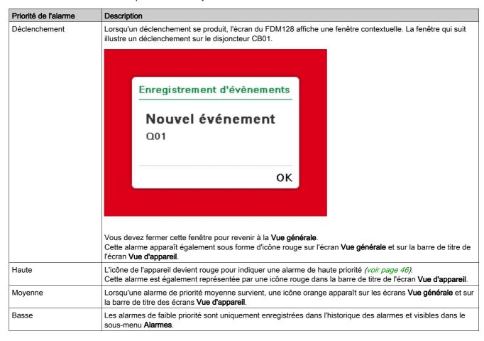
**NOTE**: Les alarmes de disjoncteur configurées à l'aide du logiciel EcoStruxure Power Commission sont enregistrées uniquement dans l'historique des alarmes et ne peuvent être consultées que dans le sousmenu d'historique des alarmes. Pour plus d'informations sur la configuration d'alarmes à l'aide du logiciel EcoStruxure Power Commission, reportez-vous à la documentation du disjoncteur.
