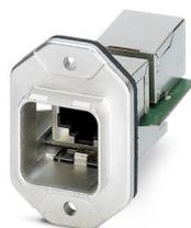
Cadre de montage RJ45, IP67, pour verrouillage Push-Pull, métallique, avec système Freenet, pour découpe de montage rectangulaire, avec joint, sans vis de fixation ; raccord de connecteur femelle à connecteur femelle inclus
