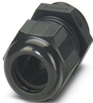
Presse-étoupe, matériau du raccordement vissé: PA, diamètre extérieur du câble 6 mm ... 12 mm, blindage: non, filetage de raccordement: Pg13,5, coloris: noir foncé RAL 9005
