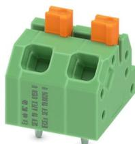
Bloc de jonction C.I., intensité nominale: 16 A, section nominale: 1,5 mm<sup>2</sup>, nombre de rangées: 1, nombre de pôles par rangée: 2, gamme d'articles: SPTAF 1/..-EL-EX, pas: 5 mm, type de raccordement: Raccordement à ressort Push-in, montage: Soudage à la vague, sens d'enfichage conducteur/circuit imprimé: 45 °, coloris: vert, Disposition des broches: Brochage linéaire, Longueur de broche [P]: 2,6 mm, nombre de picots par potentiel: 2, type de conditionnement: Plateau
