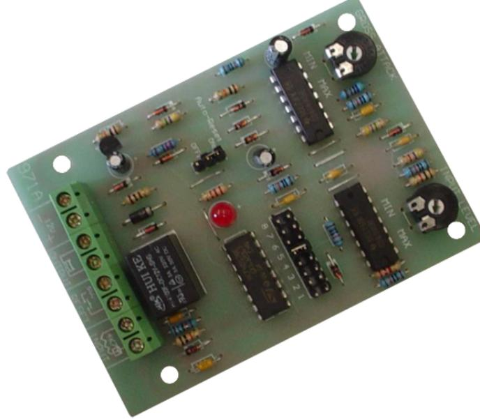
Carte compte-impulsions pour entrées à contacts rapides. Alim. 10-15 Vcc, consom. 45 mA, contact NF, réglage des impulsions de 1 à 8, vitesse et sensibilité. Dimensions : 65x90 mm.
