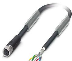
Câble préconfectionné pour bus, INTERBUS, 4-pôles exempt d'halogène, blindé, extrémité libre, sur Connecteur femelle droit M8, détrompage: A, longueur de câble: 15 m
