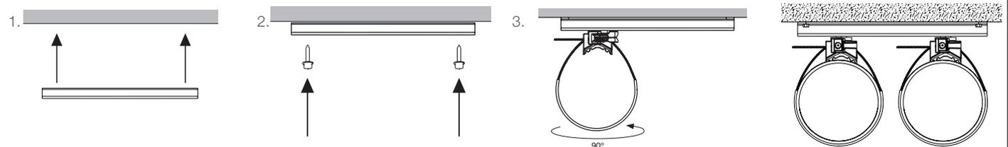
L'installation peut nécessiter l'utilisation d'une clé pour la fixation du quart de tour
