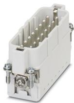
Élément de contact, nombre de pôles: 16+PE, taille: D25, nombre de raccordements par pôle: 1, Mâle, Raccordement Push-in, 250 V, 16 A, 0,14 mm<sup>2</sup> ... 2,5 mm<sup>2</sup>
