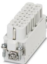
Élément de contact, nombre de pôles: 16+PE, taille: D25, nombre de raccordements par pôle: 1, Connecteur femelle, Raccordement Push-in, 250 V, 16 A, 0,14 mm<sup>2</sup> ... 2,5 mm<sup>2</sup>
