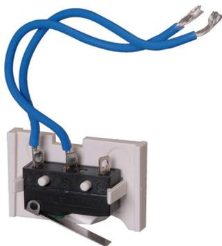
Le contact d'arrachement mural IMS-WTC doit être installé dans la partie inférieure du boîtier du module d'extension LSN ISP-EMIL-120. Une alarme autosurveillance est transmise dès que le boîtier est arraché du mur.
