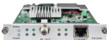
Le **multimodulateur numérique GX-BP-16C-R00** est équipé d'un connecteur de sortie coaxial RF (F femelle) et est capable de créer jusqu'à **16 multiplex numériques QAM (Annexe A/C)**. Le multimodulateur est la solution de transmodulation idéale et efficace pour la distribution de programmes syntonisés par des modules satellite ou numériques terrestres dans le même châssis ou partagés sur le même fond de panier **GALAXIA**, y compris l'entrée multicast IPTV.
