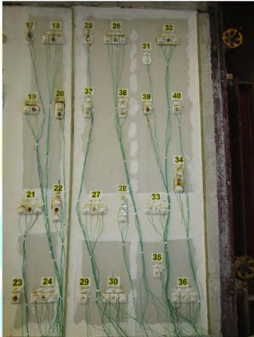
Échantillon d'essai après la simulation d'incendie d'une durée de 95 minutes
