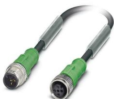
Câble pour capteurs/actionneurs, 3-pôles, connecteur mâle droit M12, détrompage: A, sur Connecteur femelle droit M12, détrompage: A, longueur de câble: 5 m, pour connecteur pour électrovanne
