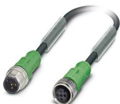
Câble pour capteurs/actionneurs, 3-pôles, connecteur mâle droit M12, détrompage: A, sur Connecteur femelle droit M12, détrompage: A, longueur de câble: 3 m, pour connecteur pour électrovanne
