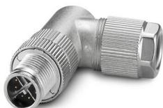
Connecteur de données, Ethernet CAT6<sub>A</sub> (10 Gbit/s), 8-pôles, blindé, connecteur mâle coudé M12 SPEEDCONNEC, X, Raccordement rapide Piercecon<sup>®</sup>, matériau de la molette: Zinc moulé sous pression, nickelé, diamètre extérieur du câble 4 mm ... 8 mm
