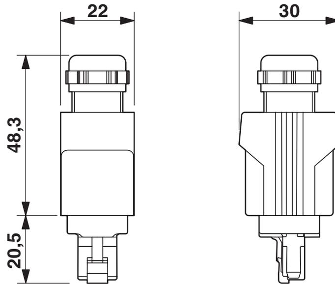
Connecteur mâle RJ45 Push-Pull, IP67
