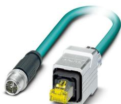
Câble de réseau, Ethernet CAT6<sub>A</sub> (10 Gbit/s), CC-Link IE CAT6<sub>A</sub> (10 Gbit/s), 8-pôles exempt d'halogène, blindé (Advanced Shielding Technology), connecteur mâle droit M12, détrompage: X SPEEDCONNEC / IP67, sur connecteur mâle droit RJ45 Push-Pull / IP67, longueur de câble: 5 m
