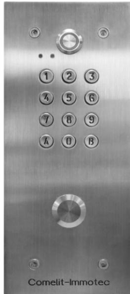
Clavier prédisposé pour recevoir un lecteur VIGIK. Plaque en inox 2mm, touches métalliques, 1 bouton poussoir de sortie commandant l'ouverture, touche 5 repérée. Fermeture par 4 vis anti-vandales. Clavier codé 2 relais, temporisation réglable 1 à 99 secondes, 100 codes de 4 à 6 termes. Alimentation 12V à 24V AC ou DC. Dimensions façade (LxH): 110x260 mm, épaisseur de 2 mm. Dimensions boîtier d'encastrement (LxH): 75x219 mm, profondeur de 45 mm.
