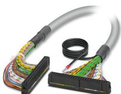
Câble rond blindé préconfectionné; raccordement 1 : IDC/FLK connecteur femelle (1x 50-pôles); raccordement 2 : IDC/FLK connecteur femelle (1x 50-pôles) (La tresse de blindage sort d'une extrémité de câble distincte.); longueur de câble: 2 m
