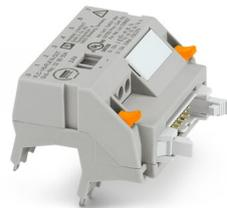
Adaptateur V8 pour 8 x PLC-INTERFACE (6,2 mm), automate: Câblage système API des cartes de sortie, raccordement 1: IDC/FLK connecteur mâle 1x 14-pôles, raccordement 2: Raccord enfichable (Encliquetable sur les 8x blocs de jonction PLC-INTERFACE), raccordement 3: Raccordement vissé 1x 2-pôles, nombre de canaux: 8, logique de commande: plusschaltend
