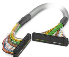
Câble rond prééquipé, exempt d'halogène; raccordement 1 : IDC/FLK connecteur femelle (1x 50-pôles); raccordement 2 : IDC/FLK connecteur femelle (1x 50-pôles); longueur de câble: 3 m
