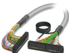
Câble rond blindé préconfectionné; raccordement 1 : IDC/FLK connecteur femelle (1x 50-pôles); raccordement 2 : IDC/FLK connecteur femelle (1x 50-pôles) (La tresse de blindage sort d'une extrémité de câble distincte.); longueur de câble: 0,5 m
