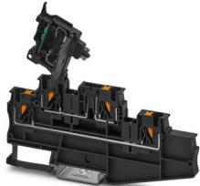
Bloc de jonction-fusibles, type de fusible: Verre / Céramique / ..., type de fusible: G / 5 x 20, tension nominale: 500 V, intensité nominale: 28 A, type de raccordement: Raccordement Push-in, Section de référence: 4 mm<sup>2</sup>, section : 0,2 mm<sup>2</sup>- 6 mm<sup>2</sup>, type de raccordement: Raccordement Push-in, Section de référence: 4 mm<sup>2</sup>, section : 0,2 mm<sup>2</sup>- 6 mm<sup>2</sup>, type de montage: NS 35/7,5, NS 35/15, coloris: noir
