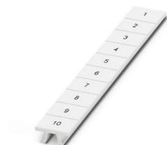
Ruban de repérage ZB, Rubans, blanc, repéré, repérable avec : CMS-P1-PLOTTER, impression transversale: numérotation continue 1 ... 10, 11 ... 20, etc. jusqu'à 91 ... 100, type de montage: encliquetage, pour bloc de jonction au pas de : 8,2 mm, surface utile: 10,5 x 8,15 mm, Nombre d'étiquettes: 10
