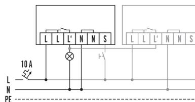
*Installation standard avec commande en option par bouton-poussoir de fermeture et raccordement en parallèle de 8 appareils au maximum*
