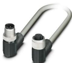
Câble préconfectionné pour bus, CANopen<sup>®</sup>, DeviceNet<sup>™</sup>, 5-pôles, blindé, connecteur mâle coudé M12, détrompage: A, sur Connecteur femelle coudé M12, détrompage: A, longueur de câble: 0,5 m, Connecteur non blindé
