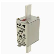
**Cartouche fusible, Basse tension, 224 A, AC 690 V, 120 kA, NH1, gL/gG, IEC, à double indicateur de fusion, pattes d'extraction conductrices**
