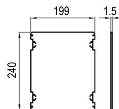
**Pattes de fixation ST VTR/ ST VTR INOX**
