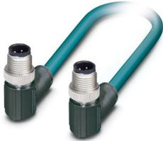
Câble de réseau, Ethernet CAT5 (100 Mbit/s), 4-pôles exempt d'halogène, blindé, connecteur mâle coudé M12, détrompage: D / IP67, sur connecteur mâle coudé M12, détrompage: D / IP67, longueur de câble: 0,5 m
