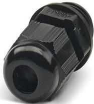
Presse-étoupe, matériau du raccordement vissé: PA, diamètre extérieur du câble 6 mm ... 11 mm, blindage: non, filetage de raccordement: M20 x 1,5, coloris: noir foncé RAL 9005, avec élément de compensation de pression et joint plat
