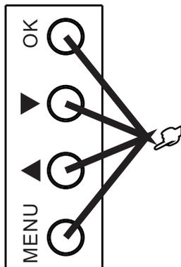
Presser les 4 touches simultanément pendant 0,5 seconde pour réinitialiser l'appareil.
