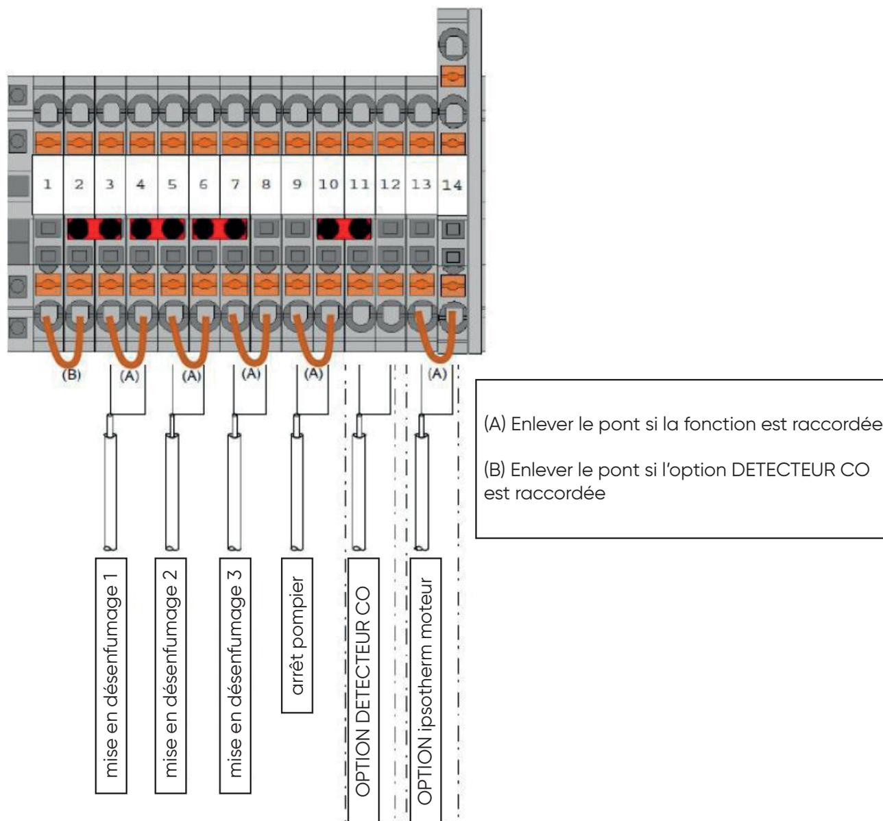
Les coffrets sont équipés de shunts (fig. ci-dessus) à retirer lorsqu'une fonction est raccordée.
