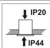
**DE** Voraussetzung für die Schutzart IP 44 der Leuchte ist die Installation in einer geschlossenen Decke! Die Schutzart IP 44 gilt nur von der Raumseite her.
