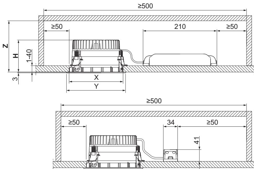
**DE** Leuchte darf nicht mit Wärmedämmung abgedeckt werden.
