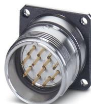
M23, Connecteur d'appareil face arrière, série: RC, droit, Verrouillage à vis, Nombre de pôles: 6, Sens de rotation: standard, type de contact: Mâle, Raccordement à sertir, Joint plat, 4xM2,5, détrompage: N, Produit de remplacement selon RoHS II sans exception 6c (Pb < 0,1 %) référence : 1240367
