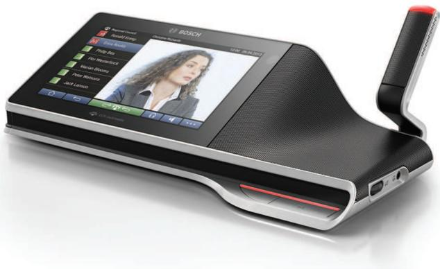
Le poste multimédia DICENTIS est essentiel pour les conseils locaux et régionaux et convient parfaitement lorsqu'un contenu multimédia est nécessaire. Il se branche et se débranche facilement du système de conférence DICENTIS à l'aide du câblage du réseau système. Les connecteurs se situent sur la partie inférieure des postes, garantissant une installation propre et nette du système. Les poste peuvent être posés sur une table ou fixés à une table à l'aide des vis de montage.
