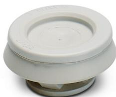
Raccordement vissé à membrane, matériau du raccordement vissé: Polypropylène, diamètre extérieur du câble 4 mm ... 10 mm, blindage: non, filetage de raccordement: M16, coloris: gris clair
