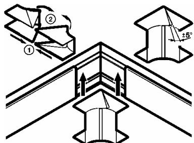
Permet la jonction en angle intérieur de deux morceaux de profilé de même section :
