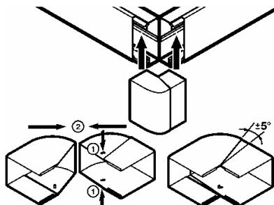
Permet la jonction en angle extérieur de deux morceaux de profilé de même section :
