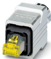
Connecteur RJ45, indice de protection: IP65/IP67, nombre de pôles: 8, CAT6<sub>A</sub>, matériau: Métal, type de raccordement: Raccordement à sertir, section raccordable: AWG 27- 24, sortie du câble: droit, coloris: argent, Ethernet
