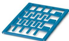
Repère pour conducteur, Planche, bleu, vierge, repérable avec : BLUEMARK ID COLOR, BLUEMARK ID, BLUEMARK CLED, PLOTMARK, CMS-P1-PLOTTER, type de montage: insertion, plage de diamètre de câble: 0,6 ... 22 mm, surface utile: 18 x 4 mm, Nombre d'étiquettes: 24
