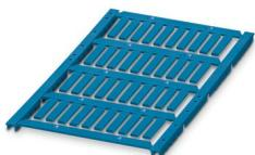
Repère pour conducteur, Plaque, bleu, vierge, repérable avec : TOPMARK NEO, LASER TOPMARK, BLUEMARK ID COLOR, BLUEMARK ID, BLUEMARK CLED, THERMOMARK PRIME, THERMOMARK CARD 2.0, THERMOMARK CARD, type de montage: insertion, plage de diamètre de câble: 0,6 ... 22 mm, surface utile: 18 x 4 mm, Nombre d'étiquettes: 40
