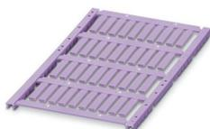
Repère pour conducteur, Planche, violet, vierge, repérable avec : TOPMARK NEO, LASER TOPMARK, BLUEMARK ID COLOR, BLUEMARK ID, BLUEMARK CLED, THERMOMARK PRIME, THERMOMARK CARD 2.0, THERMOMARK CARD, type de montage: insertion, plage de diamètre de câble: 0,6 ... 22 mm, surface utile: 18 x 4 mm, Nombre d'étiquettes: 40
