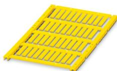
Repère pour conducteur, Planche, jaune, vierge, repérable avec : TOPMARK NEO, LASER TOPMARK, BLUEMARK ID COLOR, BLUEMARK ID, BLUEMARK CLED, THERMOMARK PRIME, THERMOMARK CARD 2.0, THERMOMARK CARD, type de montage: insertion, plage de diamètre de câble: 0,6 ... 22 mm, surface utile: 18 x 4 mm, Nombre d'étiquettes: 40
