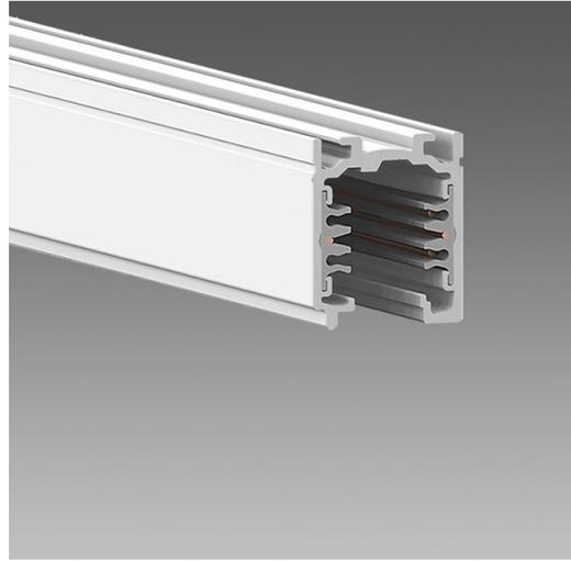
Omnitrack PLUS 6 conducteurs : Le rail Omnitrack PLUS est un système mixte triphasé avec deux conducteurs supplémentaires pour la gestion d'un signal (par exemple, DALI, DMX, etc.).
