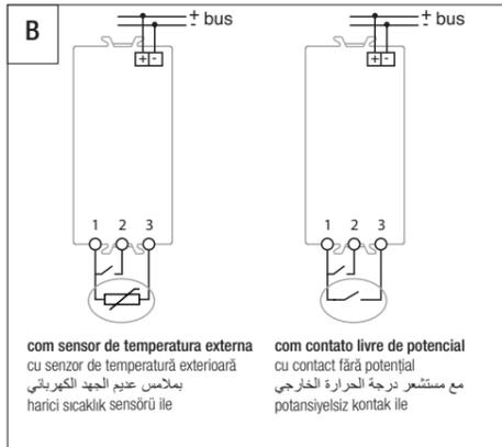
com sensor de temperatura externa cu senzor de temperatură exterioară
