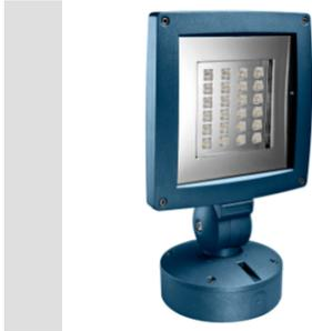
Projecteur d'illumination en aluminium moulé sous pression et peint avec des peintures en poudre de polyester après passivation trivalente Double rotation optique due à une dérivation centrale équipée d'un goniomètre gradué à l'échelle pour un pointage adéquat Verre plat trempé de 4 mm d'épaisseur Joint en silicone anti-âge Base de composants intégrés pour applications architecturales Alimentation électronique à courant constant Version à technologie LED monochrome
