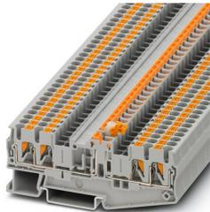
Bloc de jonction à couteau de sectionnement, Avec couteau de section tourné à 180°, tension nominale: 400 V, intensité nominale: 16 A, type de raccordement: Raccordement Push-in, Section de référence: 2,5 mm<sup>2</sup>, section : 0,14 mm<sup>2</sup> - 4 mm<sup>2</sup>, montage: NS 35/7,5, NS 35/15, coloris: gris
