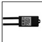
S.2407 ALIMENTATION ELECTRONIQUE NON GRADABLE 14,4W 230Vac/24Vdc IP67 Entrée: 230V Courant alterné Sortie: 24V Courant continu. Le nombre maximum d'appareils dépend de la somme des puissances unitaires de l'appareil. IP67 CLASSE II SELV Dimensions: 79 x 38 x 25 mm L'UTILISATION DU DÉCHARGEUR À SURTENSION S.2499 EST RECOMMANDÉE POUR CHAQUE BALLAST ÉLECTRONIQUE QUI DOIT ÊTRE INSTALLÉ À UNE DISTANCE MAXIMALE DE 10m DE CELUI-CI.
