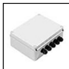
S.2404 ALIMENTATION ELECTRONIQUE NON GRADABLE IN BOX 90W 230Vac/24Vdc IP55 Dimensions: 260 x 240 x 100 mm En entrée: N° 2 presse étoupes PG 11 En sortie: N° 5 presse étoupes PG 11 CLASSE ELETRIQUE II SELV Le nombre maximum d'appareils dépend de la somme des puissances unitaires de l'appareil. L'UTILISATION DU DÉCHARGEUR À SURTENSION S.2499 EST RECOMMANDÉE POUR CHAQUE BALLAST ÉLECTRONIQUE QUI DOIT ÊTRE INSTALLÉ À UNE DISTANCE MAXIMALE DE 10m DE CELUI-CI.
