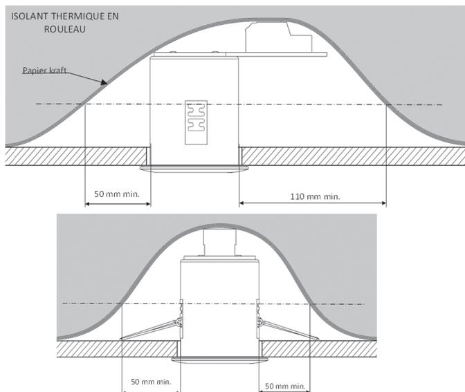
**!** Toutes les opérations indiquées ci-dessous doivent être effectuées hors tension et par une personne qualifiée. Respecter impérativement le schéma de raccordement et le sens de pose de l'isolant en rouleau uniquement, coté « papier kraft » posé sur le luminaire.
