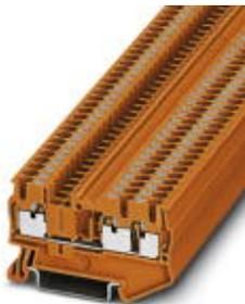
Blocs de jonction simple, type de raccordement: Raccordement Push-in, nombre de connexions: 3, section :0,14 mm<sup>2</sup> - 4 mm<sup>2</sup>, AWG: 26 - 12, largeur: 5,2 mm, hauteur: 35,2 mm, coloris: orange, type de montage: NS 35/7,5, NS 35/15
