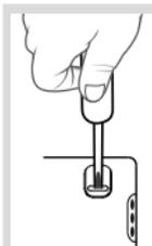
Utilisez un outil isolé électriquement pour réaliser les actions sur la touche de configuration du récepteur.
