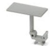
Étiquette de repérage de groupes de bloc de jonction, s'encliquette au centre des blocs de jonction à vis, à ressort ou pour raccordement rapide, repérage avec une étiquette 25 x 12 mm ou manuellement à l'aide du stylo B-STIFT, au niveau du pied avec ZB 5
