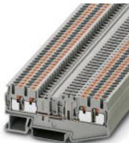
Bloc de jonction à fonction, type de raccordement: Raccordement Push-in, section : 0,14 mm<sup>2</sup> - 4 mm<sup>2</sup>, AWG: 26 - 12, longueur: 84 mm, largeur: 5,2 mm, coloris: gris, montage: NS 35/7,5, NS 35/15
