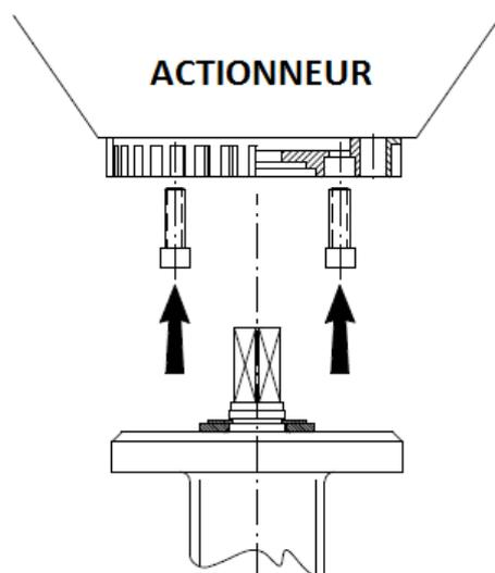
Fixer la platine sur l'actionneur à l'aide de vis 6 pans creux
